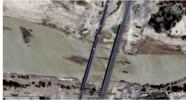
شکل (۱۰): اثر پل نهراب بر مورفولوژی و رسوبگذاری رودخانه سیستان، الف) تصویر ماهواره ای از پل نهراب و اثرات ریختاری آن بر رودخانه (فرسایش در بالادست و رسوب گذاری در پایین دست)، ب) محافظت پایه های پل نهراب با صفحات فلزی
